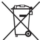
带叉的垃圾箱符号表示产品（电气和电子设备）不应在普通垃圾站废弃。请参阅当地关于电气设备废弃的管理规定。
